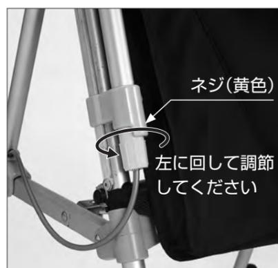
手元ブレーキが効きにくくなったり、駐車用ストッパーが車輪に当たって音がする場合は、車体の正面左右にあるネジ(黄色)を左に回して調節してください。
